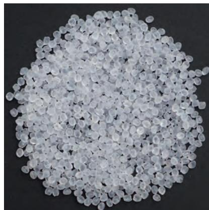
PMMA nach Trennung
