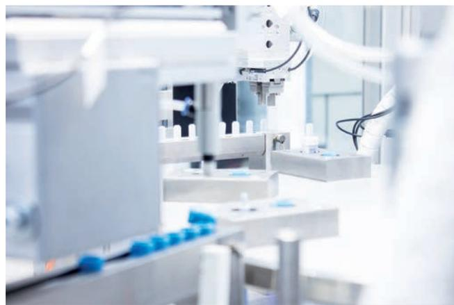
Zuführung der einzelnen Hauptkomponenten
