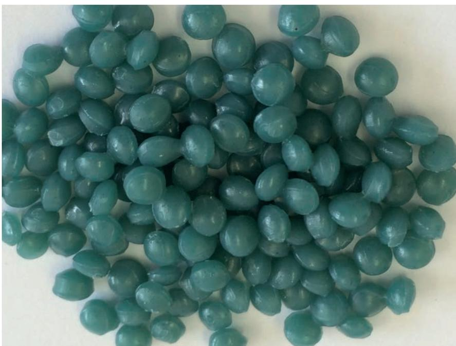
Beispiel für ein Polyamid Granulat aus der Newcycling-Anlage der APK in Merseburg
