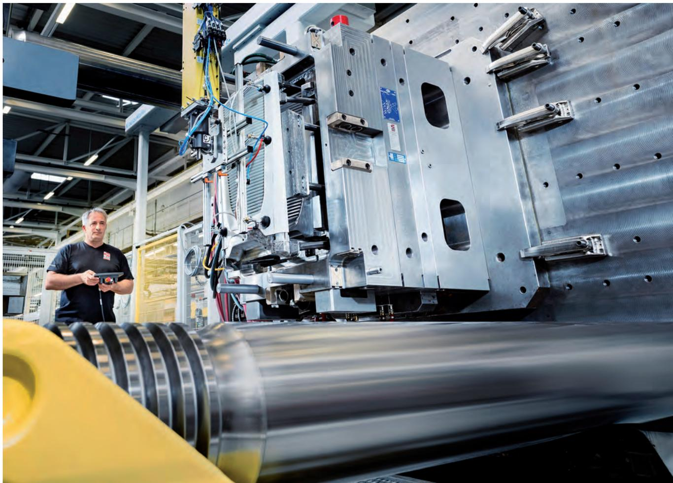
Das Dream-Team Mensch und Maschine: Auf der neuen 1.600-Tonnen-Spritzgießmaschine von LKH werden unter anderem die Lamellengitter, Ventilatorenblenden und Wannen für die Blue e+ Kühlgeräte von Rittal gefertigt.
