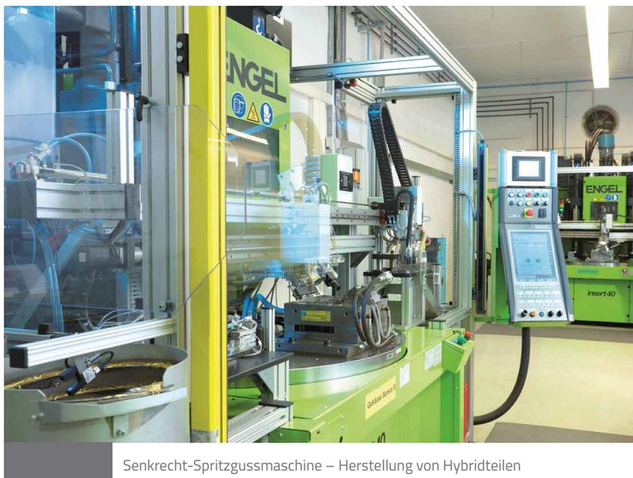
Senkrecht-Spritzgussmaschine – Herstellung von Hybridteilen
