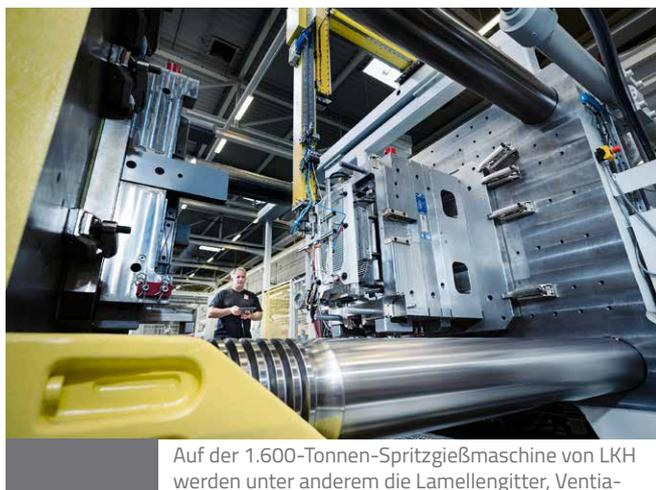
Auf der 1.600-Tonnen-Spritzgießmaschine von LKH werden unter anderem die Lamellengitter, Ventilaorenblenden und Wannen für eine hochmoderne Kühlgeräteserie gefertigt.
