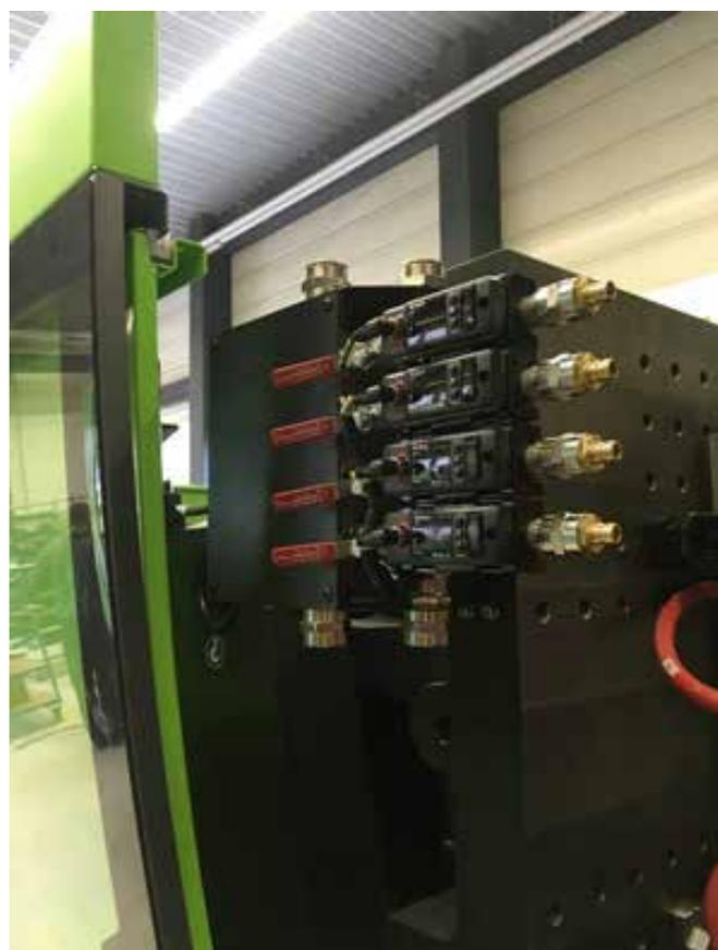
Verteilerblock ohne Querschnittsverengung
