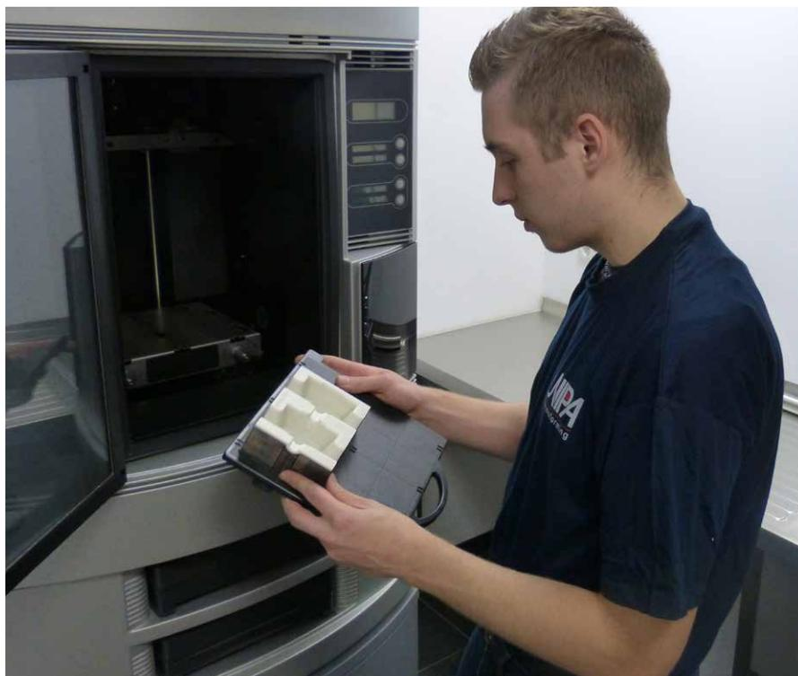
Rapid Prototyping: 3D-gedruckte Musteraufnahme
