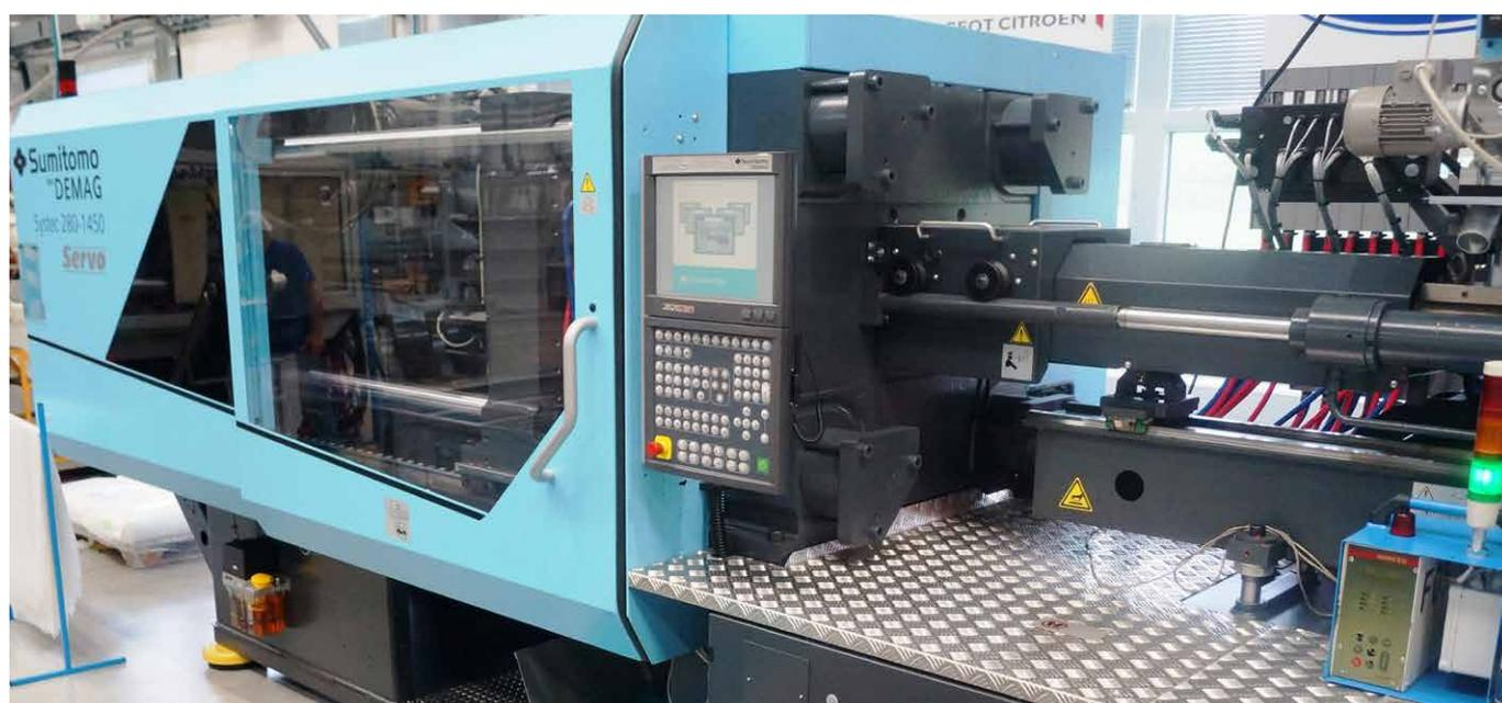
Verschlusskappenproduktion auf der neuen Spritzgießmaschine
