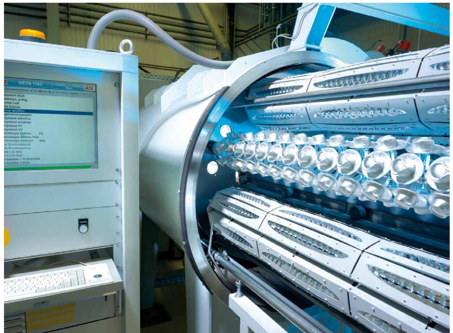
Bedampfungs-Anlage mit bestücktem Drehkorb
