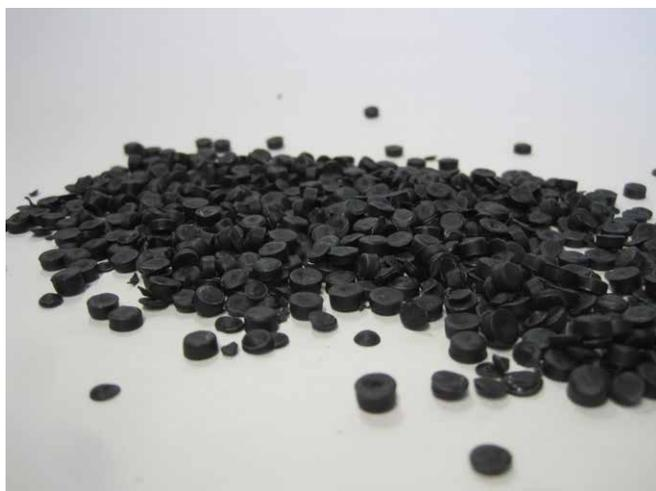
HDPE Rohr Compound – Aufbereitetes Mahlgut aus Automobil tanks
