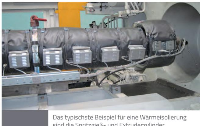
Das typischste Beispiel für eine Wärmeisolierung sind die Spritzgieß- und Extruderzylinder.
