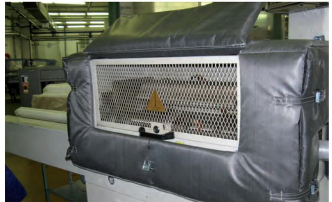
Die Wärmedämmung ist wichtig für alle beheizten Maschinenteile, nicht nur für Kunststoffverarbeitungsmaschinen.
